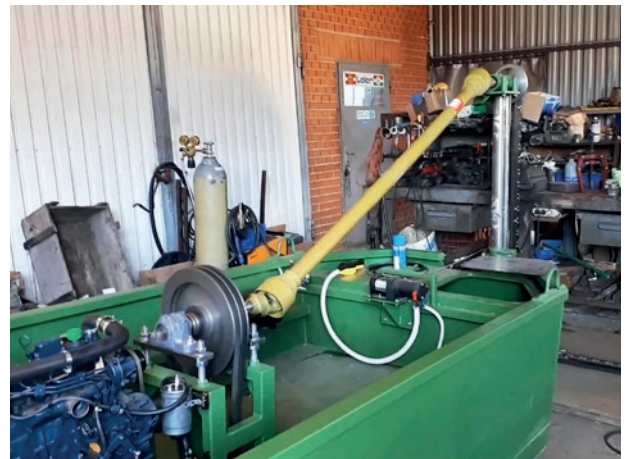
1. kép: A Kadia hínárvágó erőátviteli rendszere
