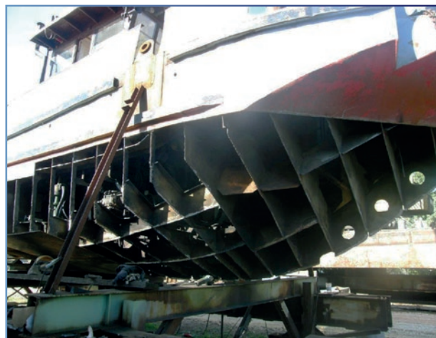
ROZMÁR hajó a fenéklemez eltávolítása után
