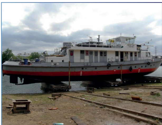
JÉGTÖRŐ VI. hajó a sólyán, vízrebocsátás közben
